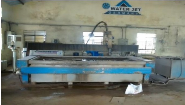
Fig. 3. Excel AWJM setup
